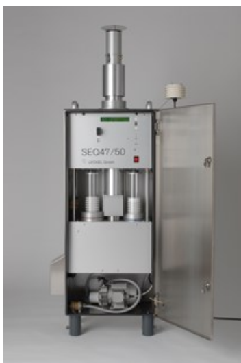
Figuur 2: Foto van de fijnstofbemonsteraar. Omgevingslucht wordt via de bemonsteringskop bovenaan aangezogen, door een filter waar stofvormige deeltjes (TSP) op achter blijven. De koker met niet-bemonsterde en bemonsterde filters en het automatisch doorschuifstelsel voor filters bevindt zich centraal in het toestel onder het bedieningspaneel.
